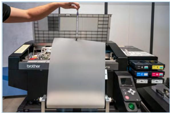
UTILE: Attaccare un dinamometro alla pellicola e srotolarne lentamente un po'. Il valore di resistenza non deve superare i 100 gr.
