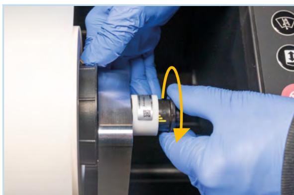
Ruotare il lato destro della manopola del freno in senso antiorario fino a battuta per sbloccare il freno.
