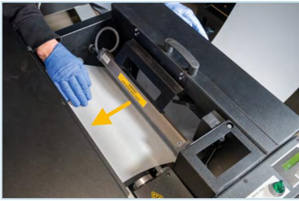
Posizionarla sotto lo ionizzatore e sul nastro trasportatore.
