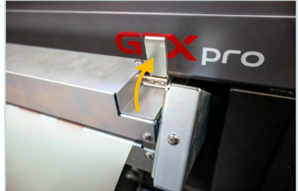
Chiudere la leva di bloccaggio spingendola verso l'alto.
