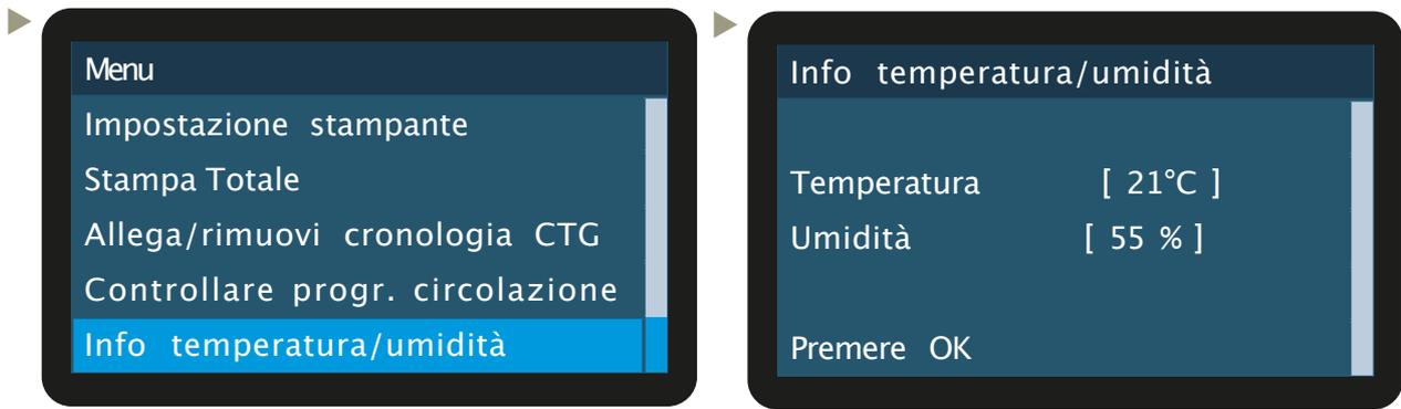
**Se la temperatura è troppo fredda:** La stampante passerà automaticamente in modalità "modalità temperatura bassa" e ridurrà la velocità. Aumentare la temperatura dell'ambiente della stampante.
