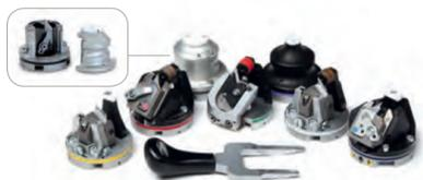
La tecnologia delle **Teste Intercambiabili** consiste in un sistema di aggancio rapido degli utensili (Brevetto Valiani) in grado di espandere la produttività di tutte le macchine Valiani. Tramite un meccanismo a magneti, gli utensili possono essere sostituiti rapidamente senza necessità di ulteriori calibrazioni. Sono disponibili utensili di taglio, 90°, 45° e 40°, utensili per la cordonatura e perforazione, utensili per la marcatura in rilievo ed un modulo porta penna.
